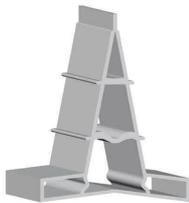
Kunststoffprofil für das problemlose Herstellen von Arbeitsfugen (Sollbruchstellen) bei Bodenplatten. Erspart den aufwändigen Fugenschnitt und Fugenverguss. Hervorragende Verzahnung im Beton. Exakte Maßhaltigkeit, daher auch als Führung von Abziehleisten bestens geeignet.
